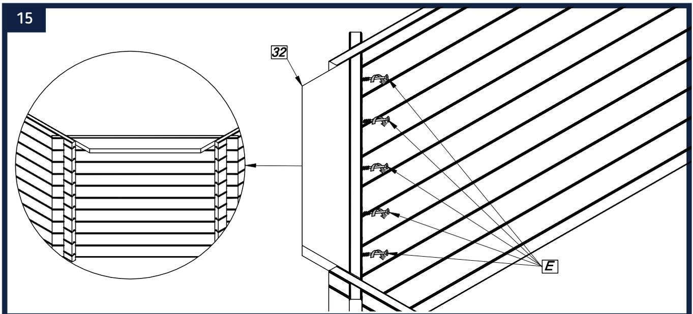
Le renfort d'escalier (32) doit ensuite être fixé à l'extérieur du bassin à l'aide de 5 vis 5 x 100 mm (E). Pour vous faciliter la tâche, utilisez une visseuse équipée d'un embout PZ2.
