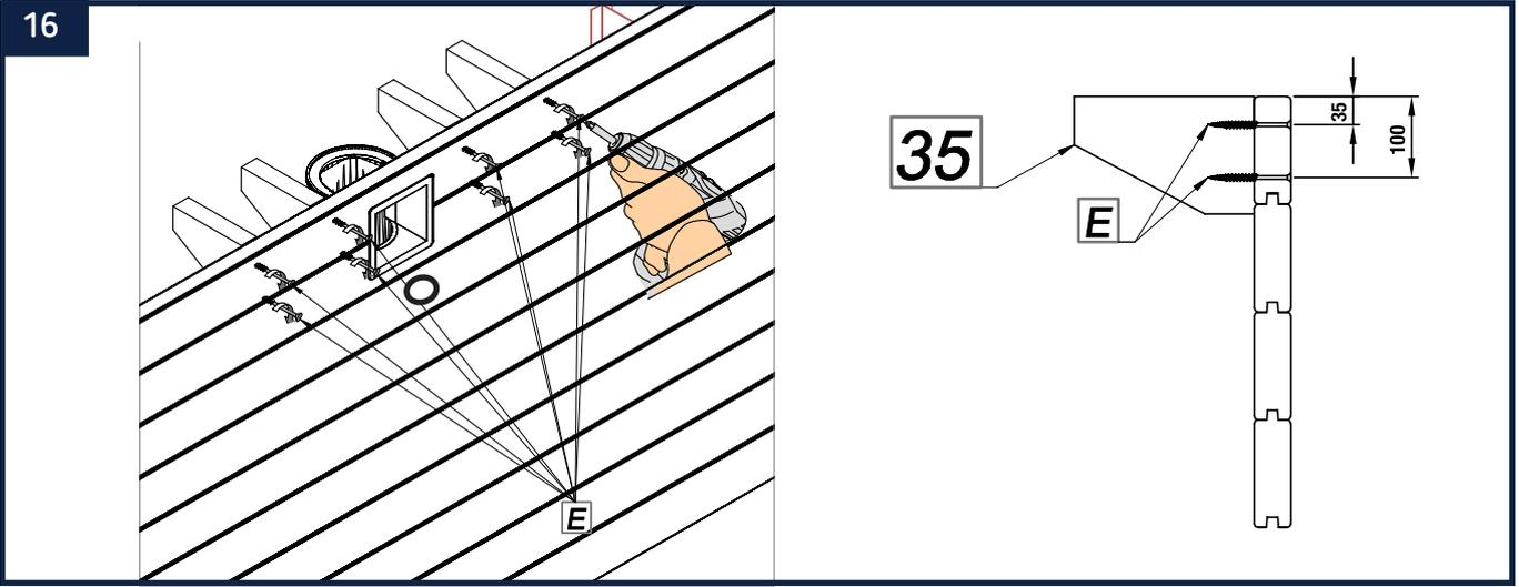
Fixez à l'extérieur de votre piscine, 22 supports de margelle (35) aux endroits mentionnés sur le schéma page 29. Pour cela, fixez chaque support à l'aide de 2 vis 5 x 100 mm (E) en suivant avec attention les côtes indiquées sur le schéma ci-dessus. Pour vous faciliter la tâche, utilisez une visseuse équipée d'un embout PZ2.
