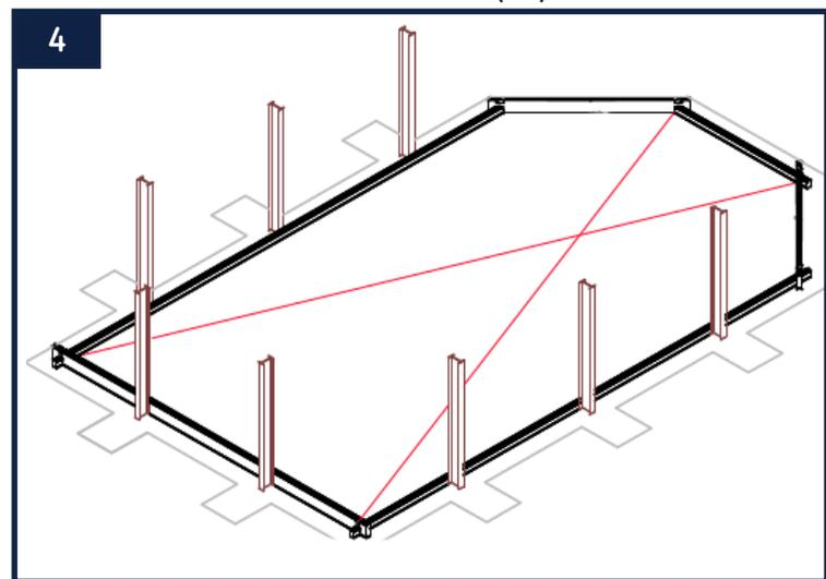
Avant de passer à l'étape suivante, vérifiez les dimensions de vos diagonales à l'aide du schéma page 22.
