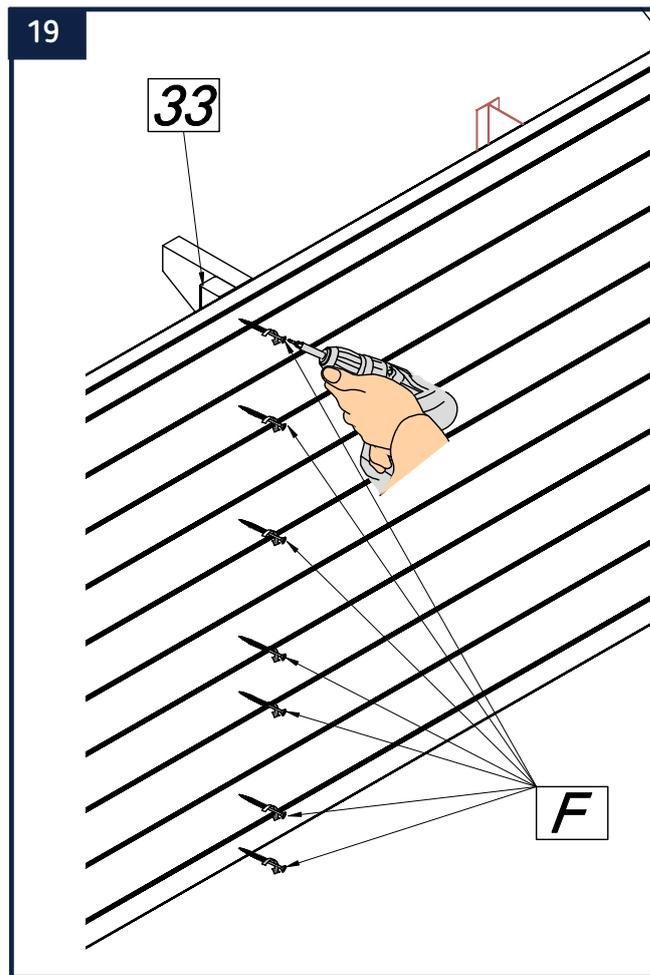
Identifiez à l'aide du schéma page 29 la disposition des renforts verticaux (33) tout autour de la piscine. Attention, ces derniers doivent être situés à l'extérieur du bassin.
