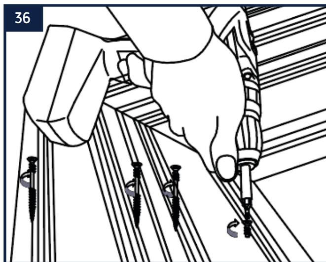
Fixez les margelles à l'aide des vis 5.3 x 80 mm (C) en commençant par les margelles intérieures. Celles-ci sont fixées sur l'ossature bois et sur le croisement des parois de la piscine. Fixez ensuite les margelles extérieures sur les supports de margelles ou sur les renforts horizontaux lorsqu'il s'agit de grandes longueurs ou de la paroi de l'escalier.
