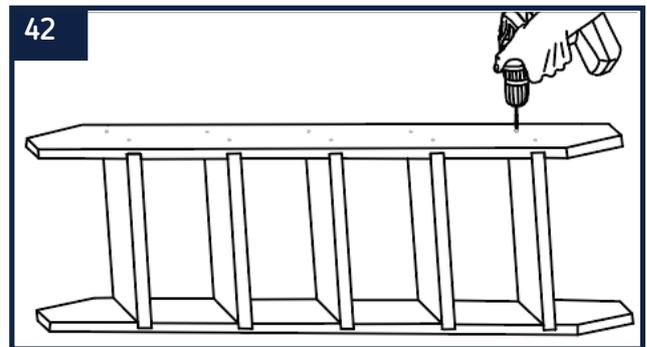
42 Une fois les trous indiqués, percez-les à l'aide d'une perceuse équipé d'un foret de 3 mm.
