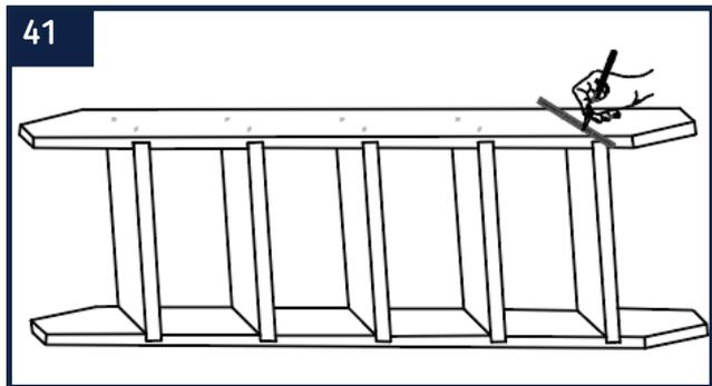
41 Utilisez une règle et un crayon de papier pour indiquer l'emplacement des trous qui permettront de fixer les marches.
