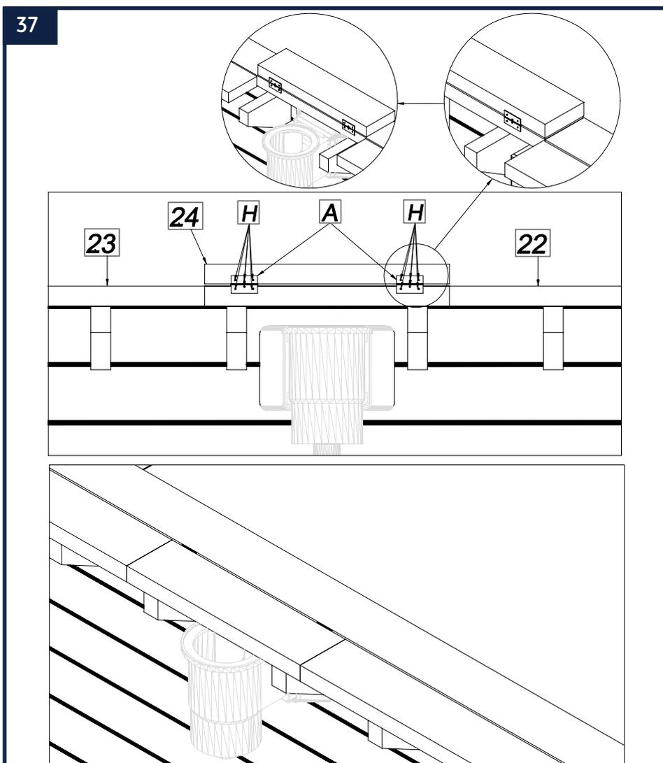
Fixez, à l'aide des vis 4 x 20 mm (H), les charnières (A) sur la tranche de la margelle amovible (24) et la tranche de la margelle intérieure (19) positionnée au niveau du skimmer comme indiqué sur le schéma ci-dessus.
