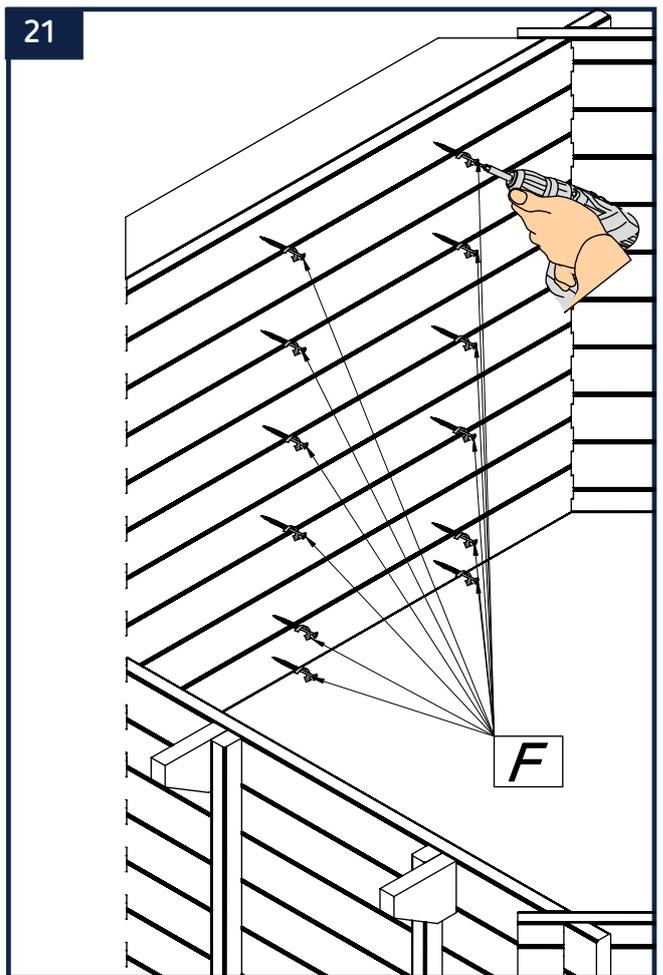
Identifiez à l'aide du schéma page 29 la disposition des renforts verticaux courts (34). Attention, ces derniers doivent être situés à l'extérieur du bassin.
