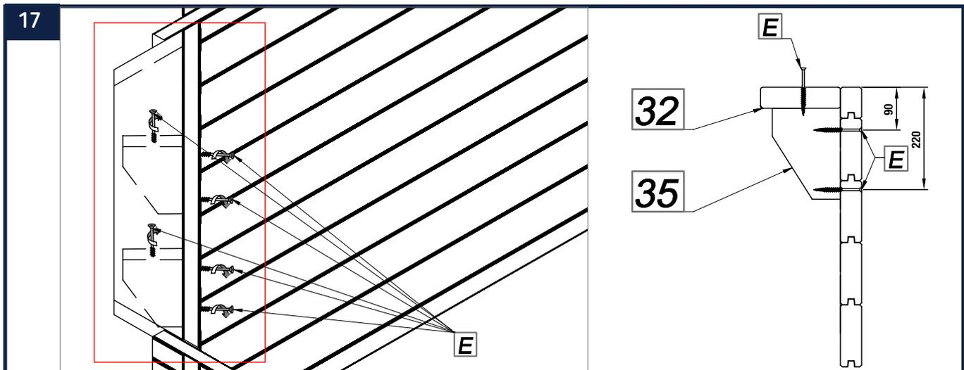
Fixez ensuite les 2 derniers supports de margelles (35) à l'aide de 2 vis 5 x 100 mm (E) en suivant précisément les indications présentées ci-dessus. Une fois cette action réalisée, fixez à l'aide d'une vis 5 x 100 mm (E) le renfort d'escalier (32) au support de margelle (35). Répétez cette action pour le second support. Pour vous faciliter la tâche, utilisez une visseuse équipée d'un embout PZ2.
