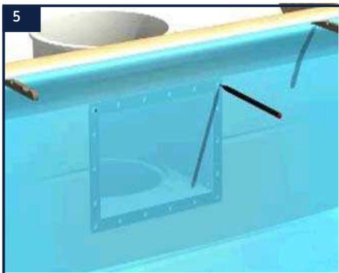
5 Remontez le niveau d'eau à 5 cm sous l'ouverture du skimmer, puis placez le deuxième joint sur la face avant du skimmer, devant le liner.
