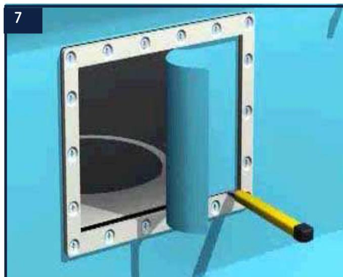
7 Découpez soigneusement le liner à l'intérieur de la bride à l'aide d'un cutter. Puis montez le niveau d'eau jusqu'à la moitié du skimmer.
